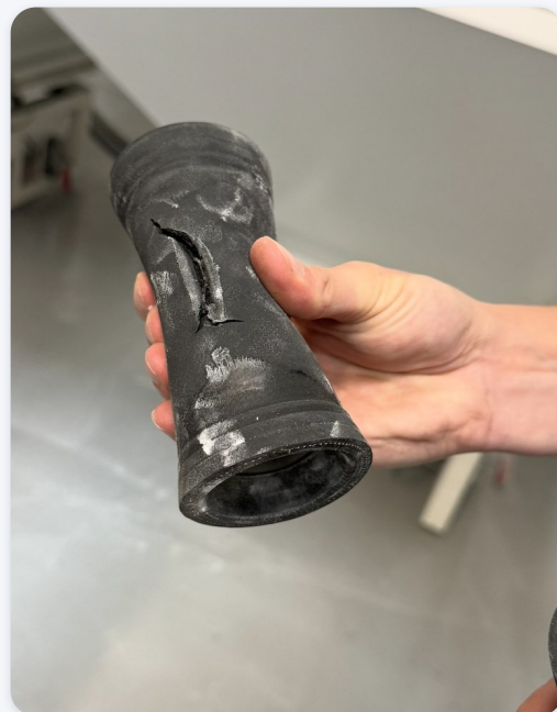
Vanne manchon fendue sous le cyclone, remplacée lors d'une visite annuelle.
