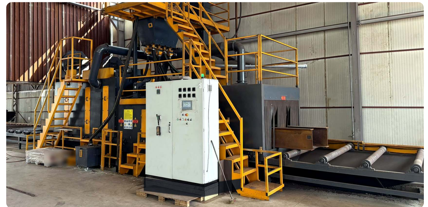
Grenailleuse tunnel à rouleaux CREDO BLAST : chargement de profilés et tôles, passage en continu, soufflage en sortie.
