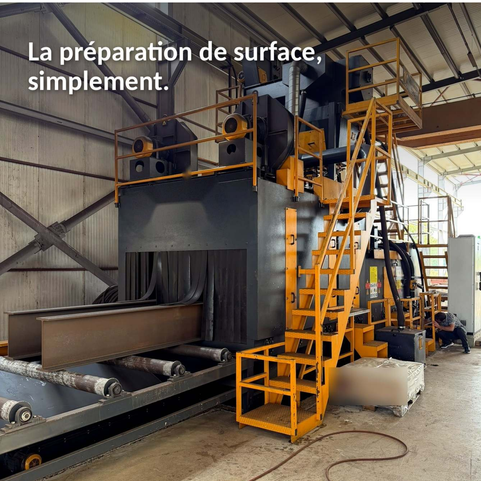
Grenailleuse tunnel à rouleaux CREDO BLAST : chargement de profilés et tôles, passage en continu, soufflage en sortie.
